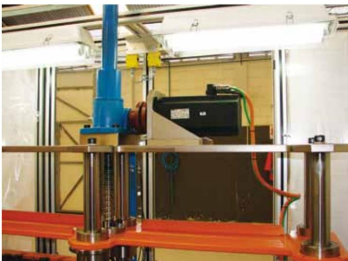
Servomotor aplicado na prensa eletrônica
