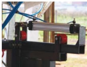
Detalhe do cilindro pneumático Parker
