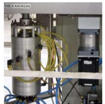
Distribuidor Pneumático Rotativo (Hexakron)
