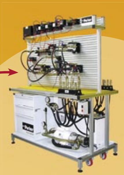
■ Modelos 2005 das bancadas com tampo vertical, fabricadas em perfil de alumínio ParFrame®
